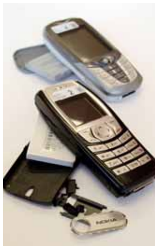
Siemens CX 65 (øverst) og Nokia 6610 ble begge ødelagt i falltesten.
