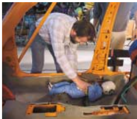
Bak testen ligger det et møysommelig arbeid. Beltet skal være like stramt på alle testene, baksetet skal skiftes mellom annenhver krasj, skader i mageregionen på dukken skal undersøkes og dukkene må repareres på «sykestua».
