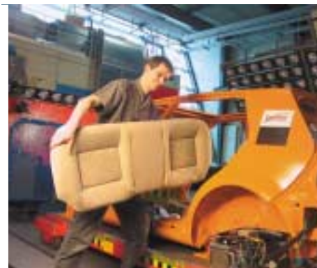
Bak testen ligger det et møysommelig arbeid. Beltet skal være like stramt på alle testene, baksetet skal skiftes mellom annenhver krasj, skader i mageregionen på dukken skal undersøkes og dukkene må repareres på «sykestua».
